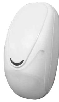
Sensor com dupla tecnologia PIR/MW com dupla análise digital, capacidade de cerca 15 m, ângulo de abertura de 90°, piroelétrico duplo elemento, resistências internas de linhas finas EOL para único e duplo balanceamento. Equipado com dispositivo tamper contra abertura, dispositivo contra deslizamento e conta impulsos. Fácil fechamento com encastro sem parafusos.
