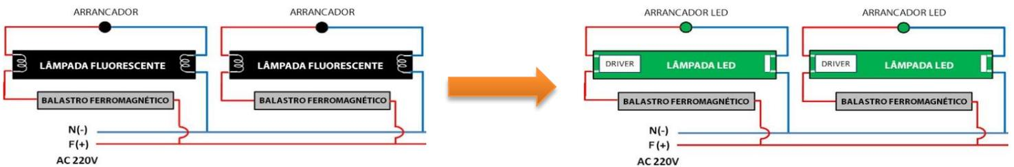
Não são necessárias alterações no esquema de ligação. O arrancador deverá ser substituído pelo arrancador LED. Se existir algum condensador no interior da luminária, este deve ser retirado.
