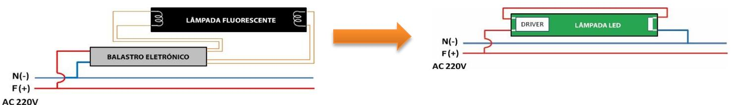
São necessárias alterações no esquema de ligação. O balastro e o arrancado deverão ser retirados. No caso de 2 lâmpadas, ambas deverão ser intervencionadas.
