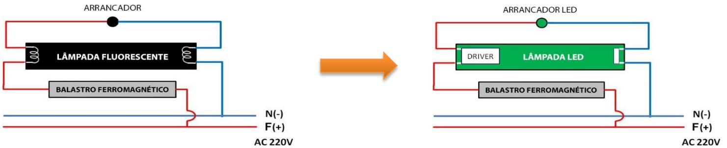
Não são necessárias alterações no esquema de ligação. O arrancador deverá ser substituído pelo arrancador LED. Se existir algum condensador no interior da luminária, este deve ser retirado.
