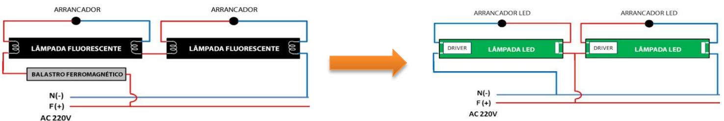
São necessárias alterações no esquema de ligação. O arrancador deverá ser substituído pelo arrancador LED. Se existir algum condensador no interior da luminária, este deve ser retirado.
